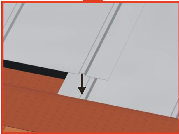
Procéder de la même façon pour la pose horizontale des panneaux solaires en utilisant les bacs Alu spécifiques
